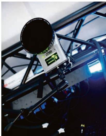
Infrarøde kameraer: Kameraene i lydstudioet fanger bevegelsene til små refleksballer på deltakerenes hoder.
