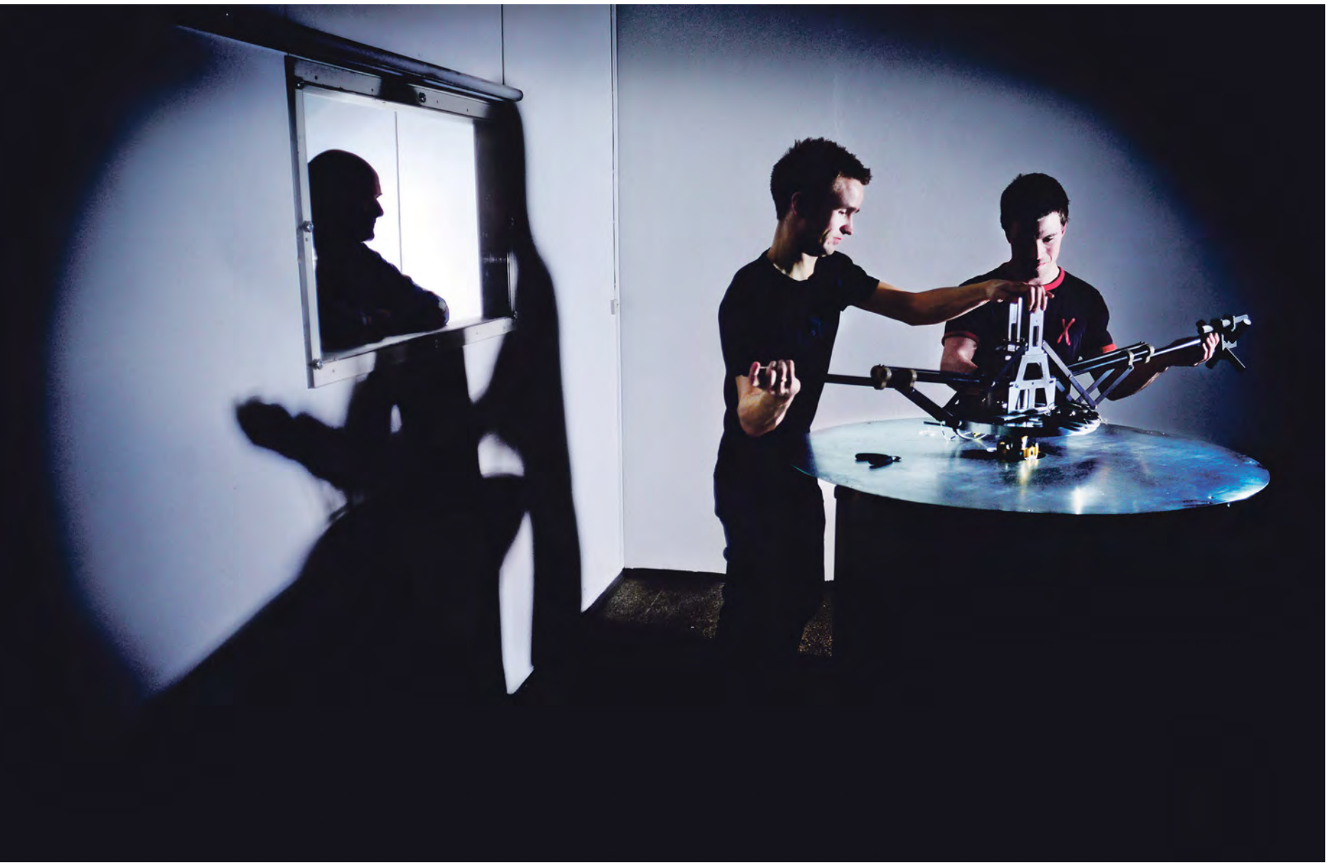
ROCKET SCIENCE: Tore André Bekkeng og Jonas Ringnes (t.h.) ved Fysisk institutt arbeider med utviklingen av mikrosatelitten «Cubestar». Her rigger de opp for å teste bomsystemet til en testrakett som skal skytes opp fra Svalbard før jul. I vinduet står senioringeniør Espen Trondsen og observerer.
