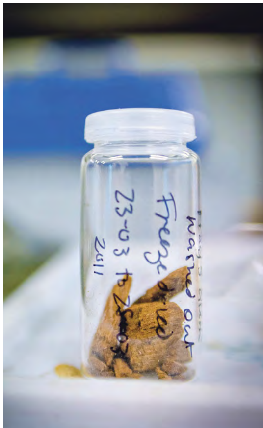
Fra Oseberg-graven: Trebiten spiser opp egen struktur etter at bevaringsteknikken fra 1906 slo feil.
