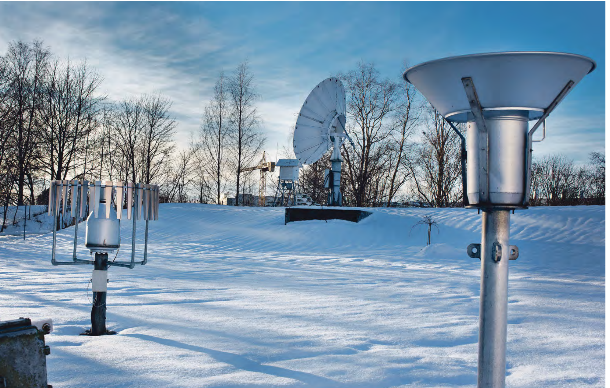
I VINDEN: Disse instrumentene i hagen ved Meteorologisk institutt på Blindern måler nedbørsmengde og vindstyrke.
